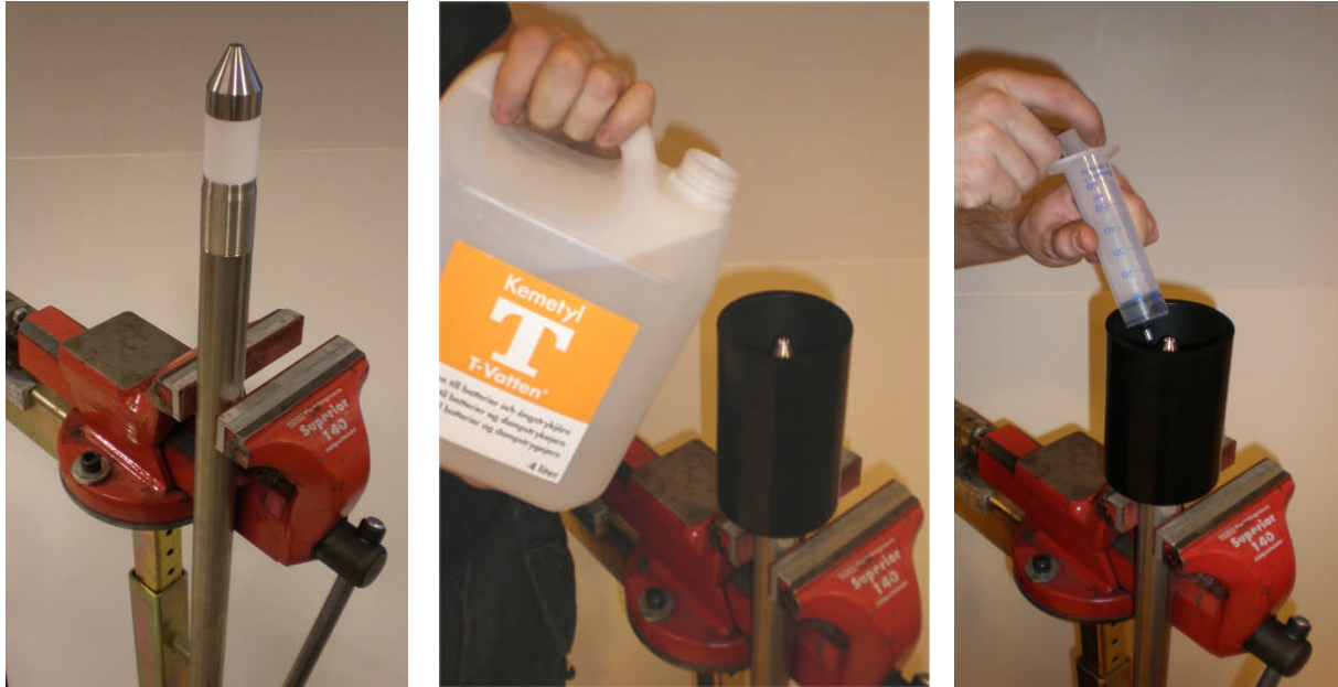
Fig. 7 – Håll PVT-mätarens filter under vatten.
