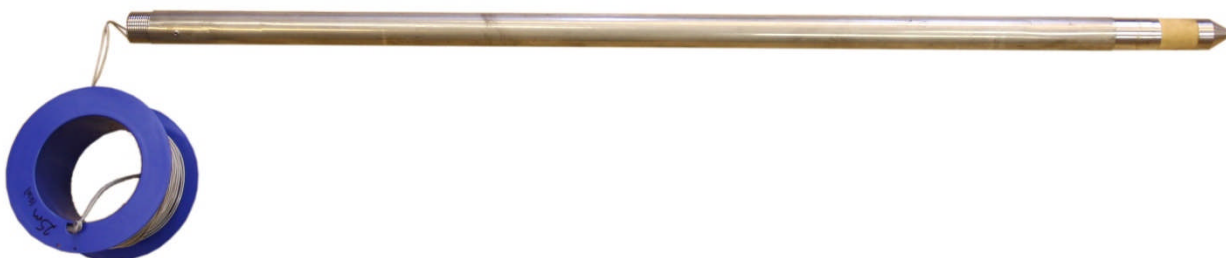
Fig. 1 – PVT-mätaren finns i flera versioner – med eller utan loggningsminne. Tryckgivare, a/d-omvandlare, mikroprocessor (med eventuellt logg-minne och batteri) – allt är integrerat i mätspetsen. Endast kabeln är synlig uppe på marken.
