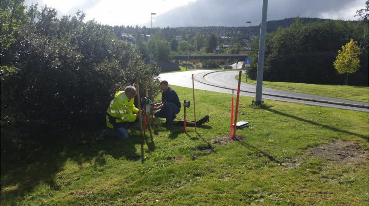
Fig. 7 – Exempel på fjärravläsning med gateway för kommunikation via mobiltelefonnätet. Portrycket övervakas på olika djup i leran nära en väg. Gör inställningar och hämta data via Internet. Ställ in gränsvärden och få lammeddelanden via SMS eller e-mail.
