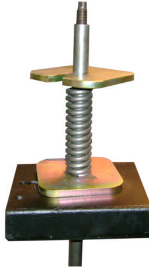
Figur. 7.3: Mekanism för att dra in vingen i vingskyddet. Notera att särskilt utformad utrustning kan förekomma, beroende på vilken typ av borrhög som används.
