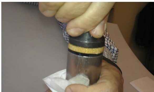
Fig. 14 – Avluftning av NOVA CPT sond
