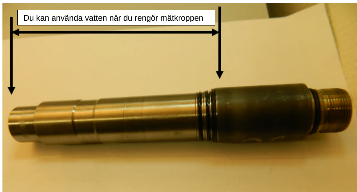
Fig. 22 – Du kan använda vatten när du rengör mätkroppen – men se till att hålla området runt ändstyckets kontakt fritt från vatten och fukt.
