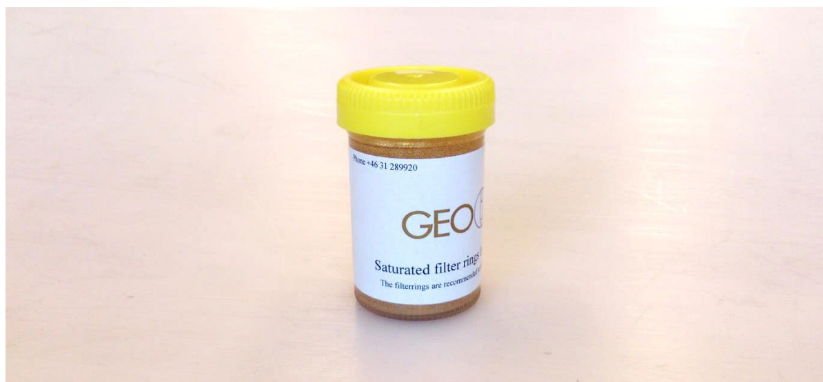
Fig. 16 – Burk med 12 avluftade filterringar, bekvämt färdigförpackade i glycerin från fabrik.
