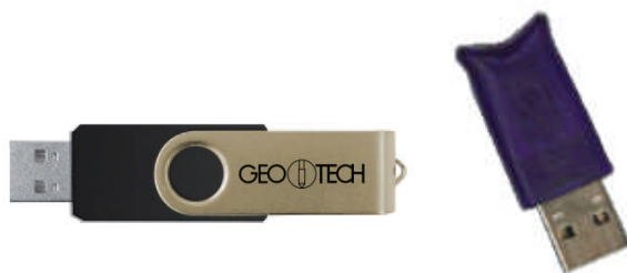
Fig. 11 – CPT-LOG mjukvara för installation på operatörens dator. Hårdvarunyckel (till höger) krävs för att köra programmet på en fristående dator. Medium för mjukvaruleverans kan variera, t ex på skiva, på USB-minne (till vänster i bild ovan) eller för nedladdning.
