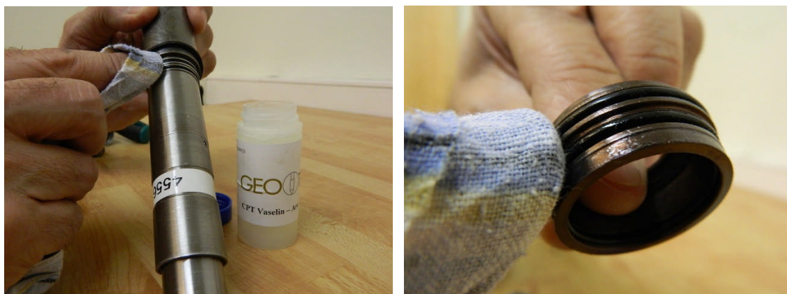
Fig. 25 – Montera tätningsringarna och smörj med lite vaselin.
