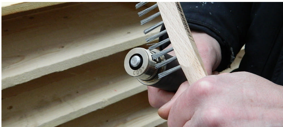
Fig. 23 – Rengöring av sondens gänga. Skydda området runt ändstyckets kontakt från vatten och fukt.
