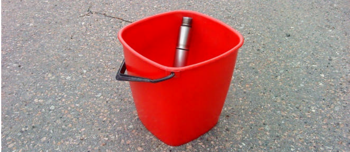
Fig. 15 – Håll sondens avluftade filterspets under vatten. Skydda ändkontakten från väta!
