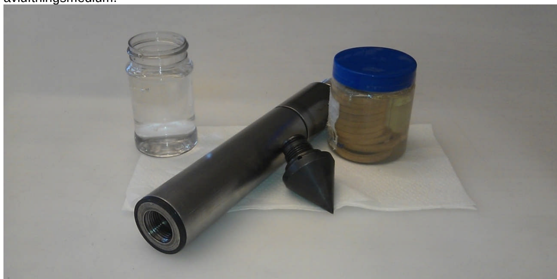
Fig. 13 – Avlufta NOVA-sonden med glycerin och mättade filterringar
