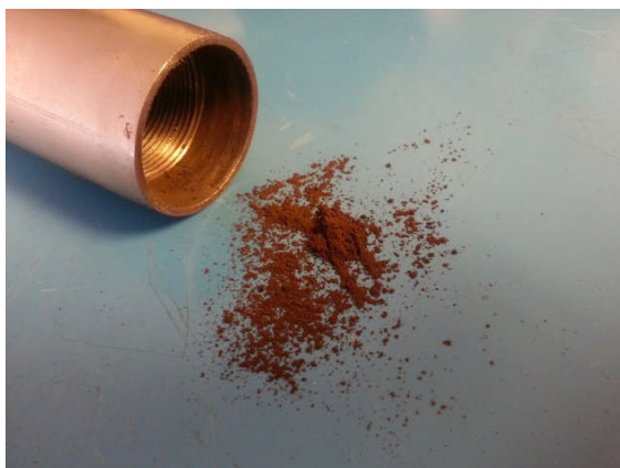
Fig. 19 – Ljudsändare: smutsig eller korroderad gänga kan orsaka funktionsstörningar. Rengör vid behov, exempelvis med en roterande borste.
