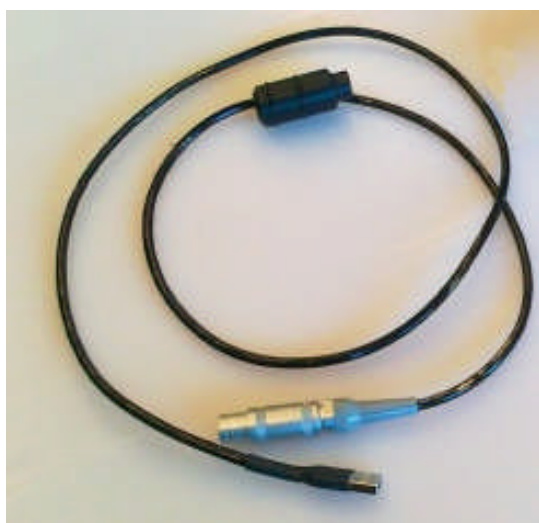
Fig. 12 – Minnestömnings-enheten kopplas mellan minnessonden och ett av operatörsdatorns USB-uttag.
